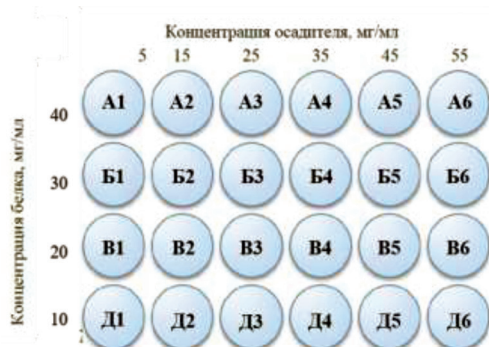
Рисунок 2 – Схема эксперимента по скринингу условий кристаллизации в планшете
